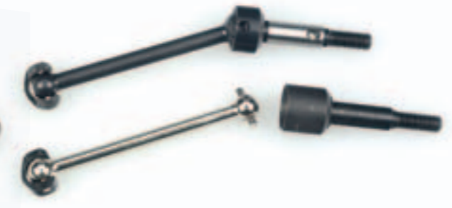
Der Ersatz der Knochenwellen in der Vorderachse durch die Kardanhalfwellen ist eine mehr als empfehlenswerte Tuningmaßnahme
