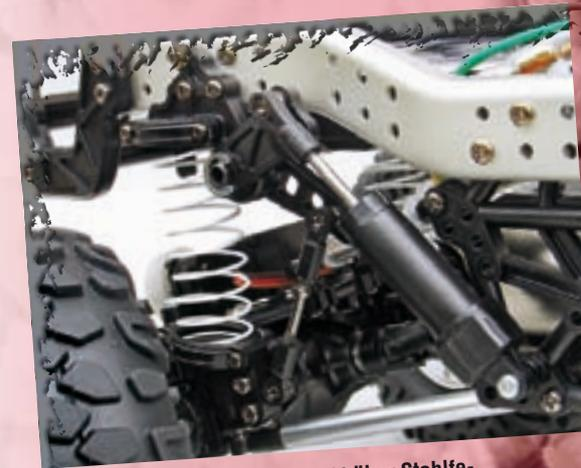
▲ Die Federung erfolgt direkt über Stahlfedern, die Dämpfung auf indirektem Weg über Umlenkhebel
