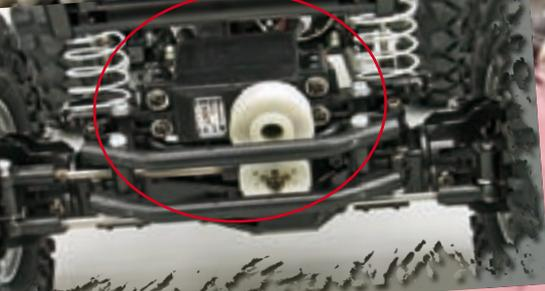
▲ Ein kräftiges Standard-Lenkservo und der solide, spielfreie Kimbrough-Servo-Saver passen genau hinter den Rammschutz der Vorderachse
