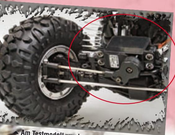
▲ Am Testmodell wurde auch die Hinterachse mit einem Lenkservo ausgestattet
