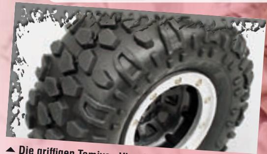
▲ Die griffigen Tamiya „Vise Crawler“-Reifen machen nicht nur optisch eine gute Figur, sie können auf unterschiedlichen Untergründen überzeugen. Die Befestigung auf den Felgen erfolgt pro Rad mit 20 Schrauben
