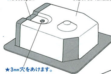
BA2 3×10mm 3×10mm タッピングビス Tapping screw Schneidschraube Vis taraudeuse
