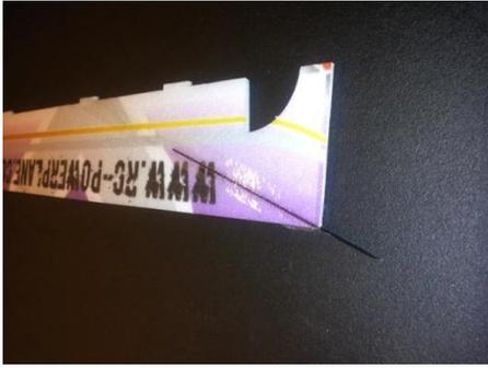
Abb.5 Zeigt das 3mm Flachprofil, welches in den Schlitz mit Uhu-Por© eingeklebt wurde und dient später als Hecksporn.
