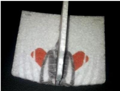
Abb. 11: Rumpfnase Epp Unterteil wird auf den Epp Mittelteil mit Uhu Por© geklebt.
