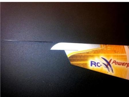
Abb.4 : Verkleben des 3mm Flachprofil mittels Uhu-Por© auf der Nasenleiste der Fläche. Das Reststück der Kohleleiste kann gleich als Hecksporn hinten am Rumpf mit Uhu-Por© eingeklebt werden. Auf dem Überstand wird dann später gelandet. Nehmen Sie ein anders Stück 3mm Kohleflachprofil und kleben es in den unteren Schlitz bis außen an die Fläche.
