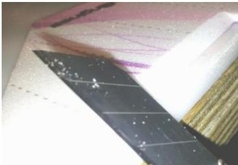
Abb2: Alle Ruderkannten werden im nächsten Schritt im 45Grad Winkel oder etwas mehr an geschrägt. Dazu verwenden Sie ein scharfes Cuttermesser und Schleifpapier. Bitte beachten Sie dass die Oberseite komplett erhalten bleiben muss. Es wird nur die Unterseite an geschrägt!
